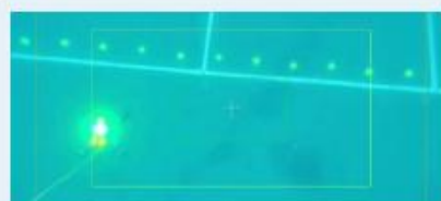
ASV船底カメラ：光る点がROV、点列はマーカー
