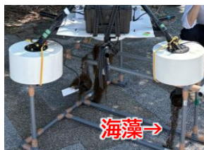
海藻巻き込みによる 定点保持ブイの スラスタ故障の様子
