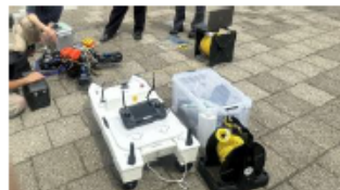
機材一式（ASV・ROV・送信機）
