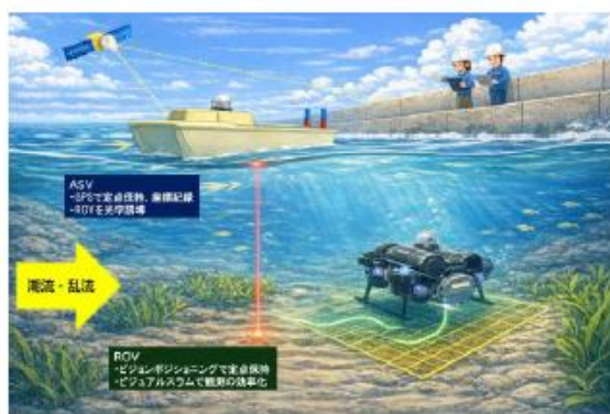
システムのイメージ図（ASVとROVの連携）
